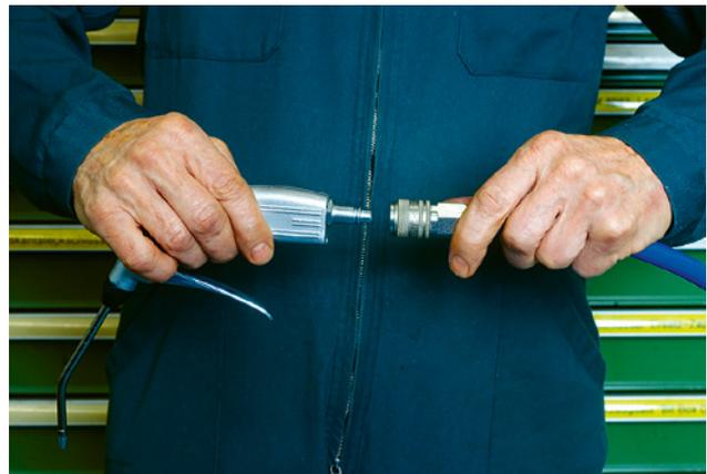
6 Zum Anschliessen Sicherheits-Kupplungen verwenden.
