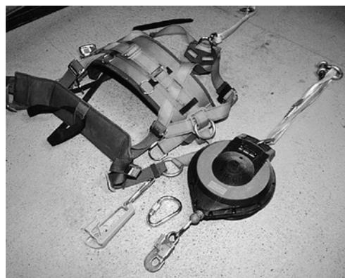
10 Auffanggurt, Hilfsmittel (Karabiner usw.) und Höhensicherungsgerät mit Hochziehkurbel für die Rettung.
