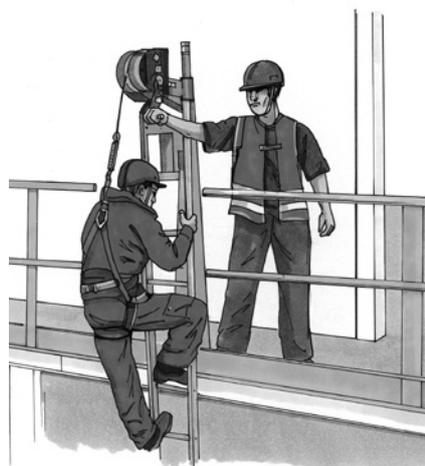
12 Siloeinstieg mittels Leiter. Nur zulässig in Kombination mit einem Höhensicherungsgerät mit Rettungseinrichtung.
