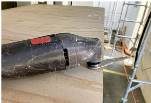
3 Machine électrique de découpe de joints à lame oscillante.
