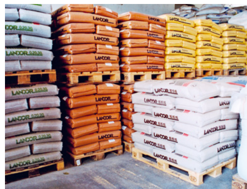
5 Deposito di sacchi su palette di legno. Per non pregiudicare la qualità del prodotto, l'altezza della catasta deve limitarsi a due palette.
