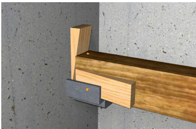
11 Per evitare il ribaltamento le travi devono essere bloccate con dei cunei.
