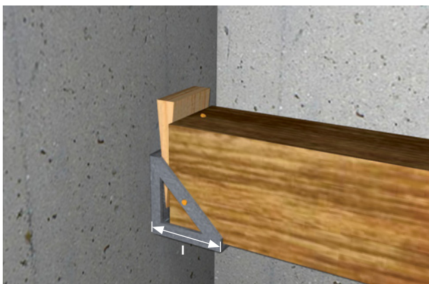
10 Il travetto ha una sufficiente lunghezza di appoggio. Il travetto e il cuneo sono fissati tra di loro con un chiodo. Il chiodo o la vite impediscono l'estrazione del travetto dalla propria sede.
