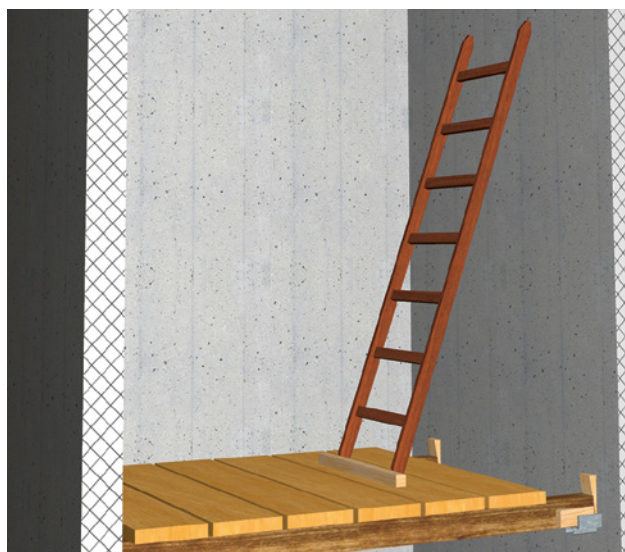
13 Per garantire un impiego in sicurezza, le scale a pioli vanno usate correttamente (angolo di appoggio di 70° circa, assicurate contro lo scivolamento, in perfetto stato).
