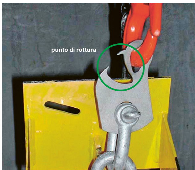
20 Verificare la portata dei punti di aggancio e ancoraggio: dispositivo di prova con punto di rottura nominale definito.
