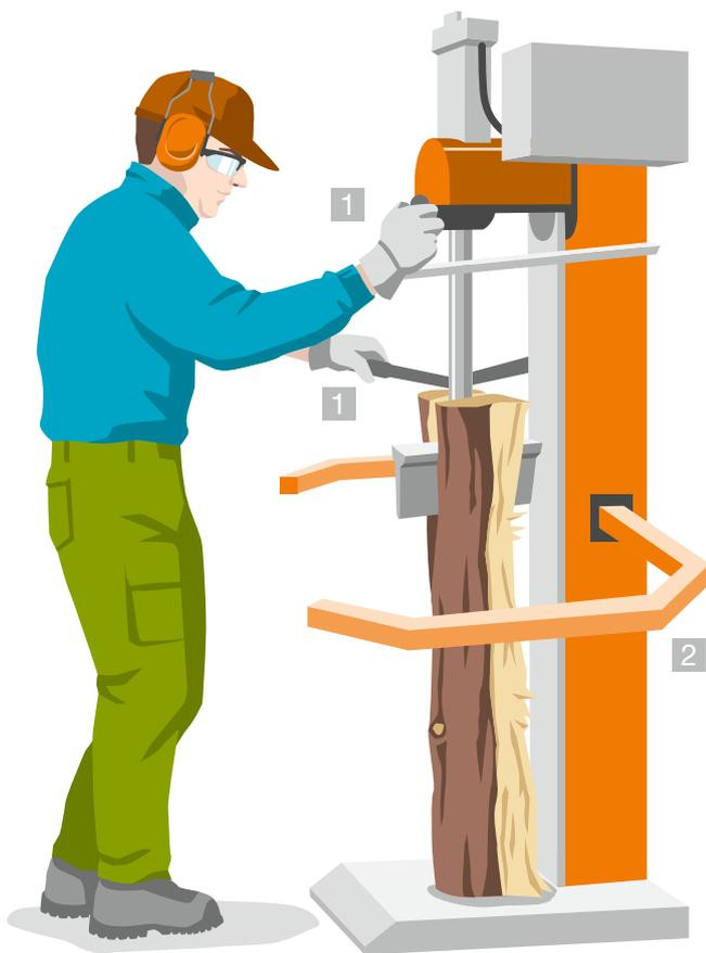
Unfälle an der Spaltmaschine haben oft schwerwiegende Folgen, zum Beispiel den Verlust eines Fingers oder der ganzen Hand.
