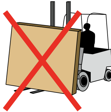
15 Nicht zulässig: stehender Transport von Holzelementen
