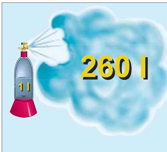
Fig. 12: Expansion volumique du propane lors de la vaporisation [4].
