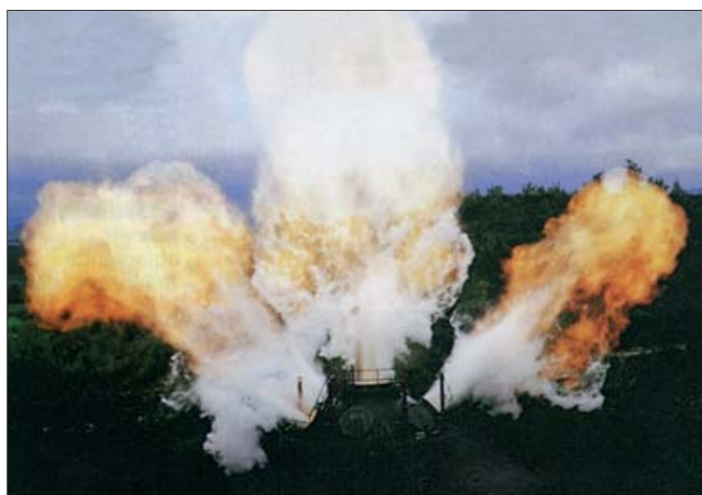
Fig. 8: Explosion secondaire à l'extérieur du récipient [5].
