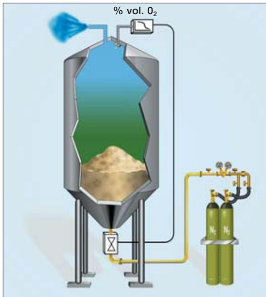
Fig. 31: Inertage avec azote et surveillance de la concentration en oxygène [3].
