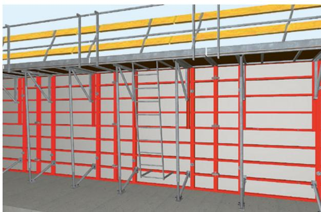
3 Casseratura a telaio con puntelli di stabilizzazione
