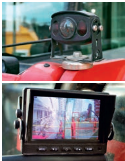
Kameras auf Maschinen von Losinger Marazzi warnen vor möglichen Zusammenstößen mit Fussgängern.
