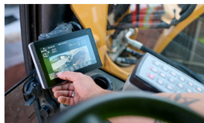
3 Macchina edile con telecamera di retromarcia
