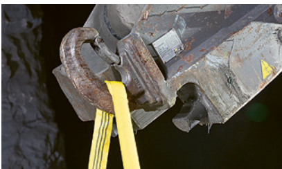
1 Dispositivo di imbracatura con sicura nel gancio
