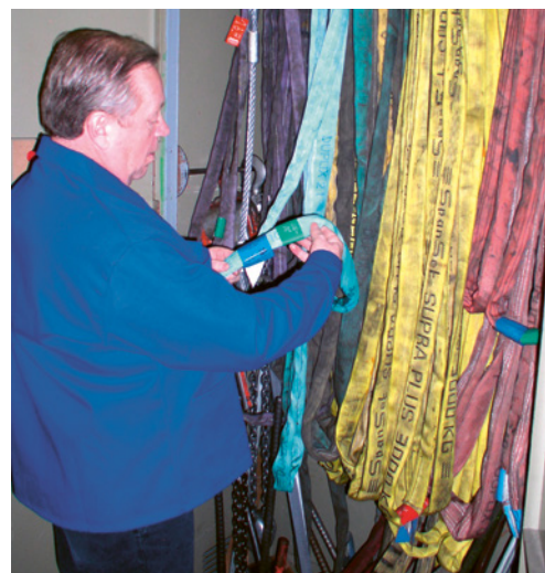
6 Controllo degli accessori di imbracatura da parte di una persona qualificata.
