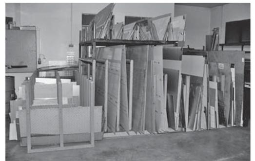
Fig. 6: rastrelliere per lo stoccaggio di lamiere intere o resti di lamiera.
