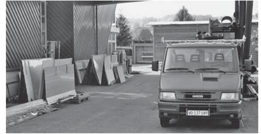
Fig. 1: ricevimento della merce con rastrelliere per lo stoccaggio temporaneo in verticale
