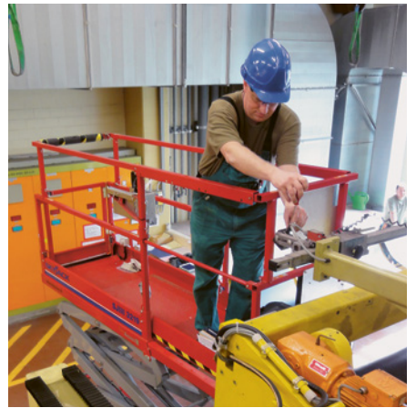
5 Für die Schmierarbeit in der Höhe wird eine Hubarbeitsbühne verwendet.
