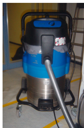
1 Aspirateur de classe H selon la norme EN 60335-2-69 avec spécification amiante
