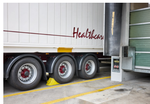
7 Mit einem Keil gesichertes Fahrzeug an einer Rampe
