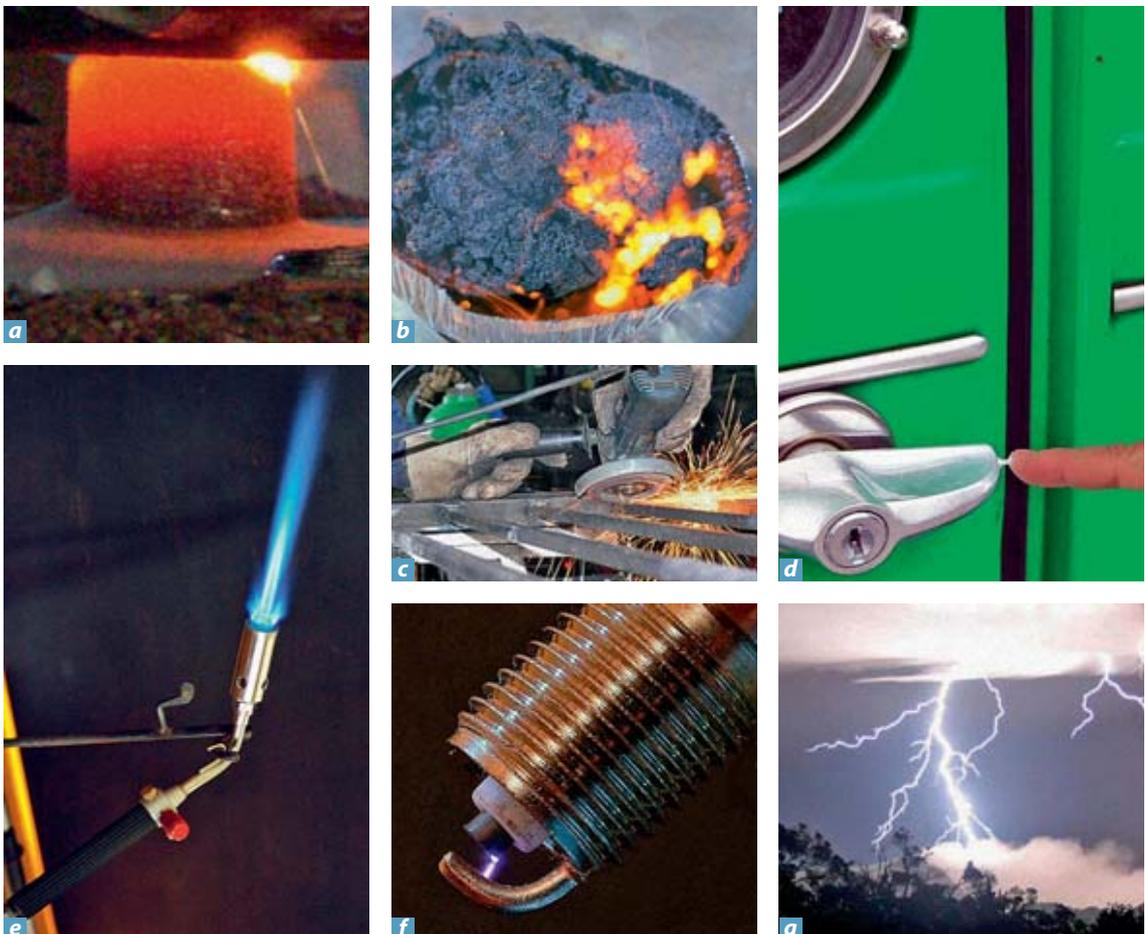
**Bild 5** Beispiele für die in der Praxis bedeutendsten Zündquellen: **a)** heisse Oberfläche **b)** Glimmnest **c)** mechanisch erzeugter Funke **d)** elektrostatischer Funke **e)** Flamme **f)** elektrischer Funke **g)** Gewitterblitz
