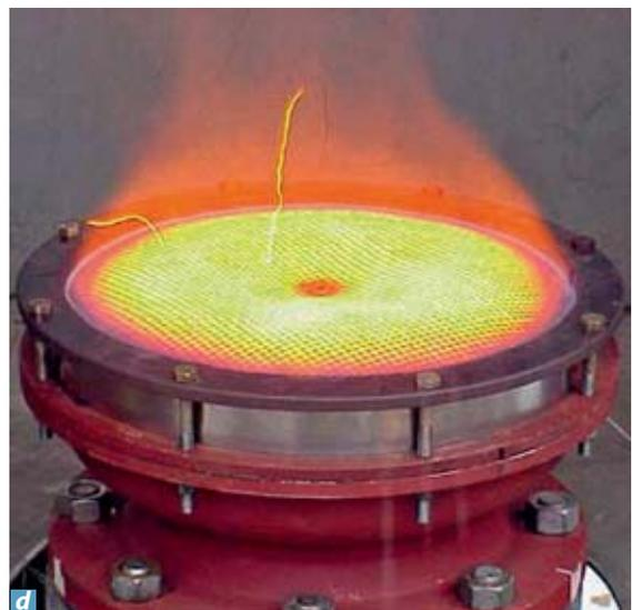
**Bild 15** Explosionstechnische Entkopplung von Gasen und Dämpfen durch Flammendurchschlagsicherungen: **a)** Flammensperre (Element Bandsicherung) **b)** Deflagrationssicherung (Schnittmodell) **c)** Detonationssicherung (Schnittmodell) **d)** Dauerbrandsicherung
