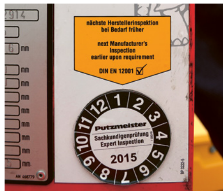
10 Wann die nächste Instandhaltung fällig ist, wird z.B. mit einer Prüfplakette am Gerät ersichtlich.
