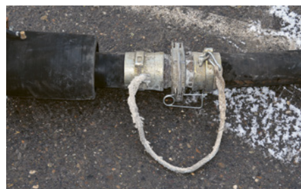
8 Endschlauchsicherung gemäss Herstellerangaben
