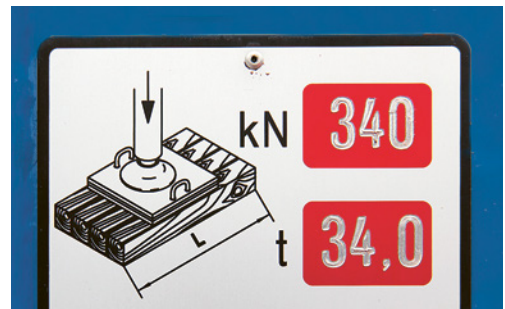
2 An jedem Stützbein ist die Eckstützkraft angegeben. Diese Angabe muss immer leserlich vorhanden sein. Angaben über die Standfestigkeit sind auch der Betriebsanleitung zu entnehmen.
