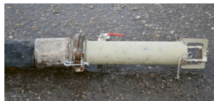
9 Beim Ausstossen mit Luft muss zwingend der Ballfangkorb eingesetzt werden.
