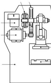
Presse mécanique à servomoteur (protecteurs de la zone des outils non représentés)
