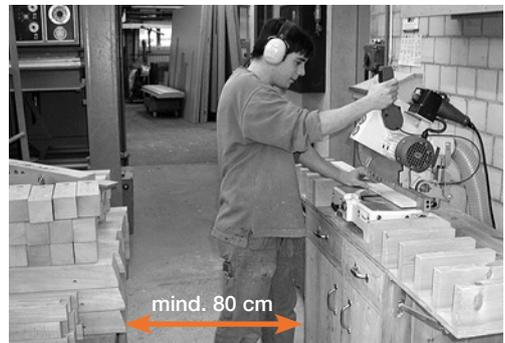
3 Für ein sicheres Arbeiten sollte die Bedienungsperson mindestens 80 cm freien Raum an der Maschine haben.
