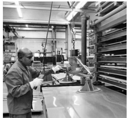
Fig. 2: préhenseur à ventouse utilisé pour soulever une tôle.
