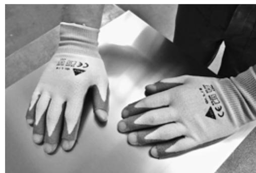
Fig. 7: gants bien ajustés avec bout des doigts libre.
