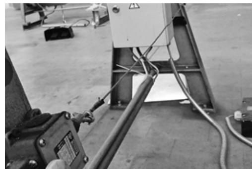
Fig. 6: câble de déclenchement pour arrêt d'urgence sur toute la longueur du cylindre.
