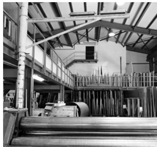
Fig. 8: support central destiné à l'alimentation des tôles instables de grandes dimensions.
