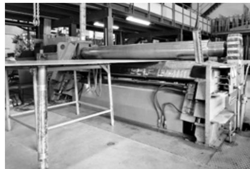
Fig. 5: table de travail pour alimenter la rouleuse avec des tôles instables de grandes dimensions.
