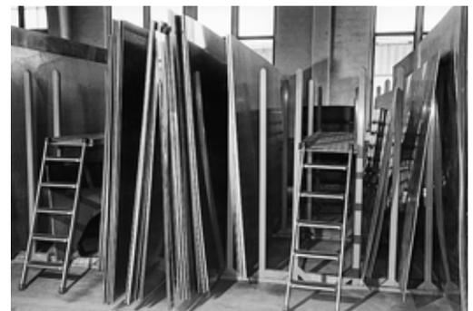
Fig. 3: entreposage vertical des tôles.
