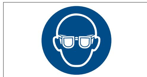
5 Le signal d'obligation «Protection oculaire obligatoire» doit être apposé sur la perceuse de manière bien visible.
