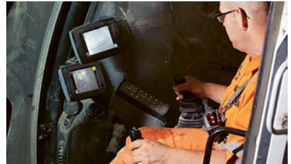
3 Baumaschine mit Rückfahrkamera
