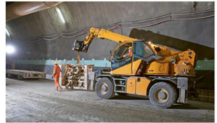
3 Führen einer Last mit Baumaschine
