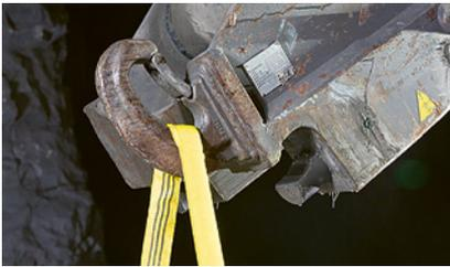
1 Anschlagvorrichtung mit Hakensicherung
