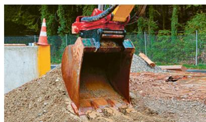
3 Schnellwechsel-Systeme: Gegendrucktest durchführen
