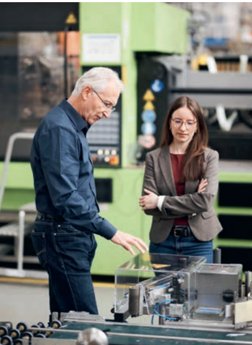
Uwe Margraf e Julia Willi esaminano la calotta di protezione aggiunta alla macchina per l'etichettatura dei cartoni.
