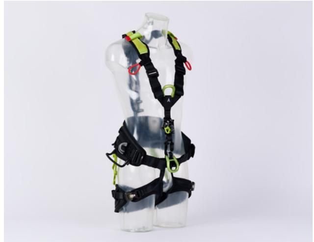
**19** Kombierter Auffanggurt (SN EN 361) mit leichtem Brustgurt, integriertem Hüft- (SN EN 358) und Sitzgurt (SN EN 813) mit seitlichen und zentralen Befestigungselementen und -ösen
