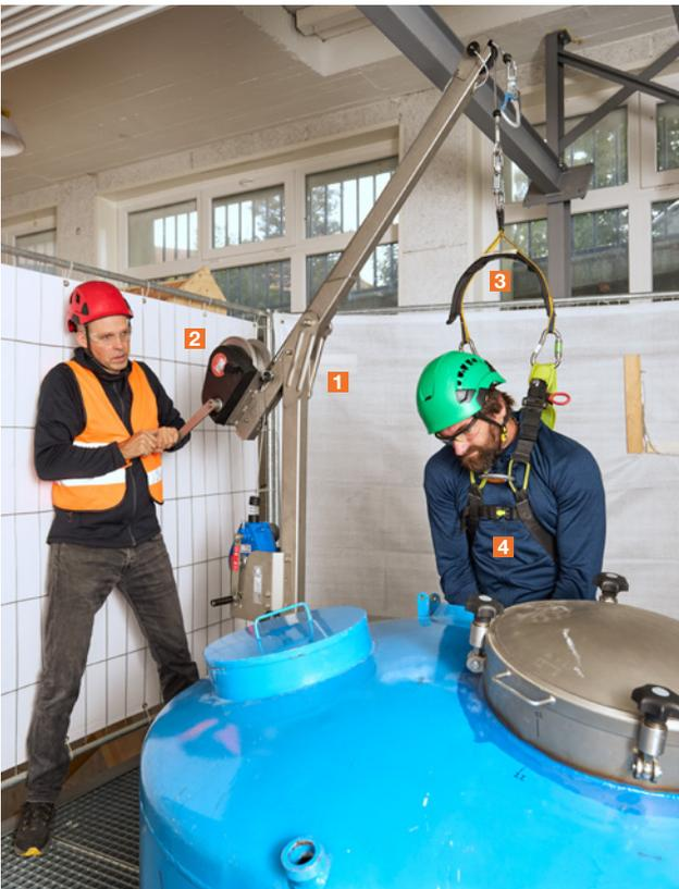
9 Rettungssystem: 1 Davit als Anschlageneinrichtung, 2 Rettungshubwinde, 3 Verbindungsmittel, 4 Gurt
