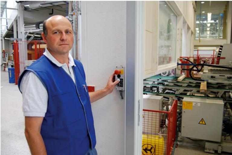
Ruedi Scherer, chef de l'entretien fait une démonstration du dispositif d'interverrouillage des portes: la machine ne peut pas être démarrée tant que la porte est ouverte.
