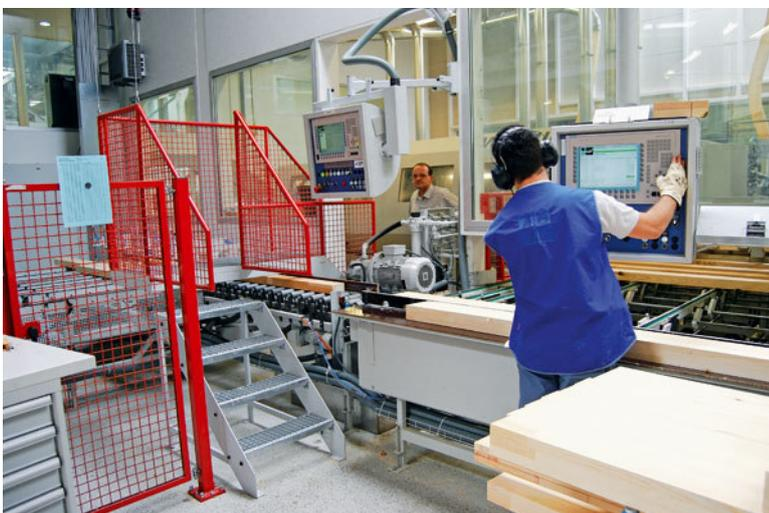
Une série d'écrans de contrôle pivotants permet aux employés de superviser constamment chaque processus de production.
