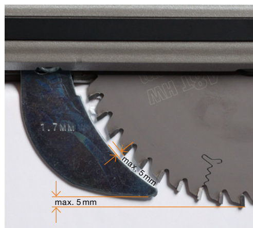
2 Segga circolare portatile con cuneo fenditore regolato correttamente
