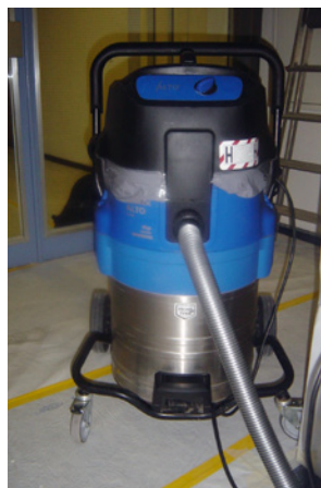
4 Aspirateur de classe H selon EN 60335-2-69, spécification amiante
