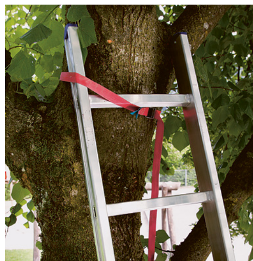
4 Le sommet de l'échelle est attaché au tronc.
