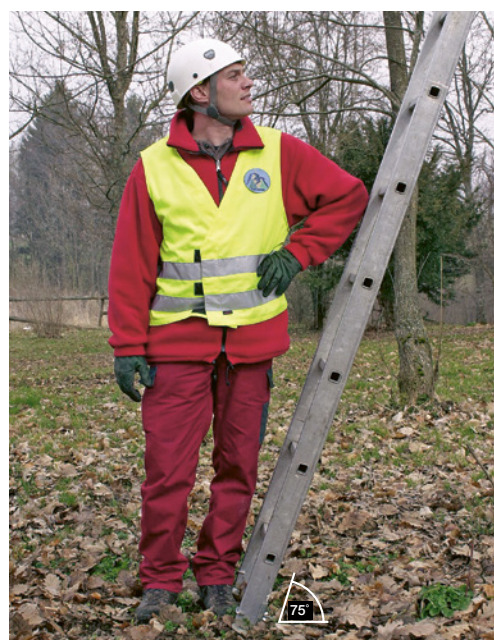
2 Le test du coude permet de déterminer l'inclinaison correcte d'une échelle. Un angle d'inclinaison d'env. 75° garantit une sécurité maximale et une ascension facile.
