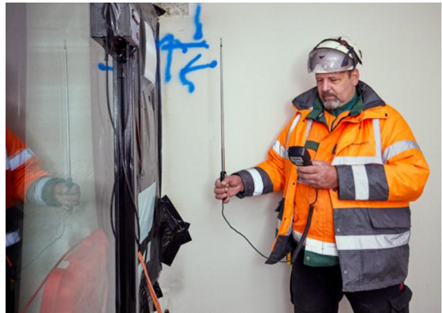
2 Contrôle de l'efficacité de la ventilation de la zone à assainir
