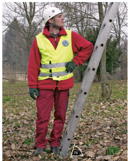
2 Die richtige Neigung lässt sich mit der Ellbogenprobe bestimmen. Bei einem Anstellwinkel von etwa 75° stehen Leitern am sichersten und können am bequemsten bestiegen werden.
