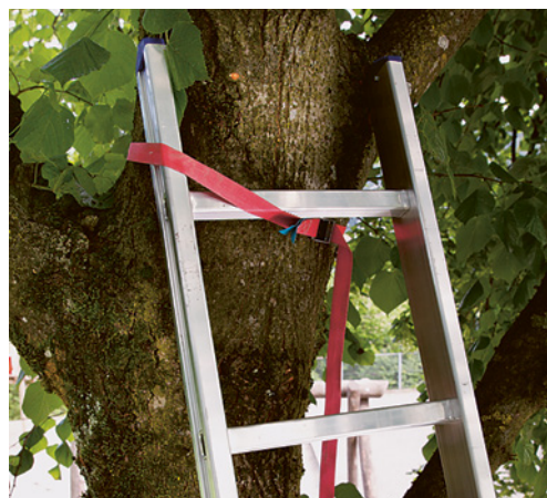
4 Kopf der Leiter am Baum gesichert
