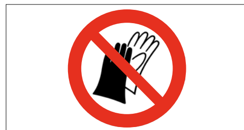
6 Il est interdit de porter des gants pendant le fonctionnement de la machine.
