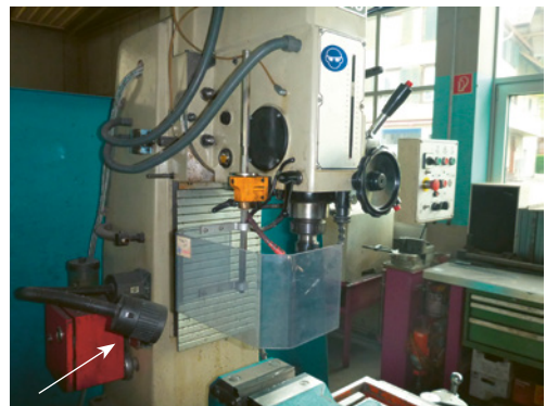
2 Une lampe d'appoint (à gauche sur l'image) assure un bon éclairage de la zone de perçage.
