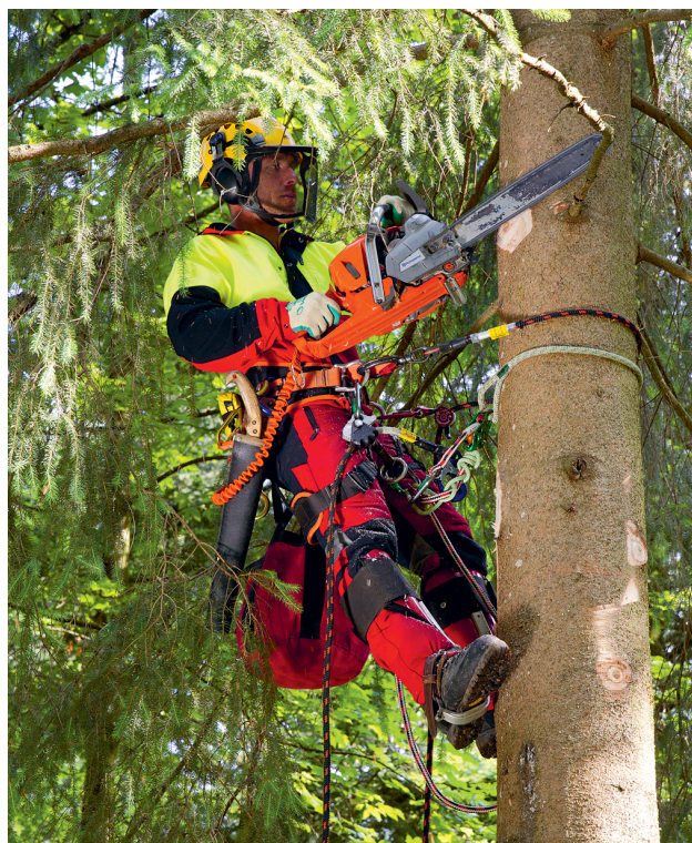
Lavori con la motosega: doppia sicurezza con il cordino di posizionamento costituito da un cavo d'acciaio
