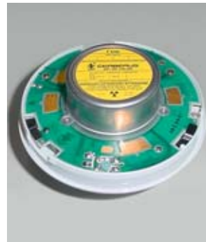
4 I rilevatori antincendio di vecchia generazione possono contenere una sorgente radioattiva. Questi rilevatori sono meglio noti come rilevatori a ionizzazione.
