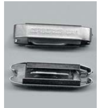
5 I vecchi scaricatori di sovratensione contengono materiale radioattivo.
