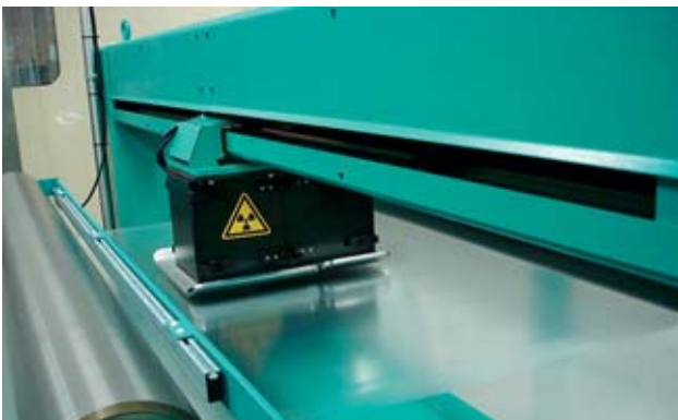
3 Sorgenti radioattive per la misurazione di spessori.
