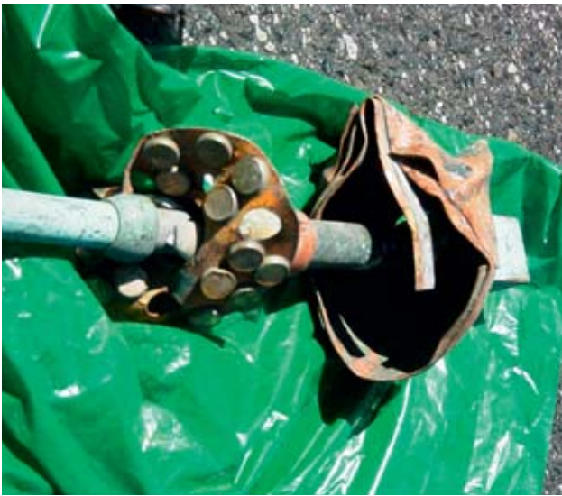
8 Parafulmini degli anni settanta contenente una sorgente radioattiva.
