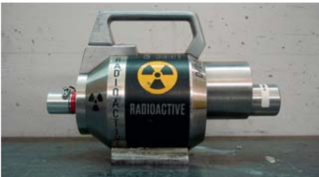
1 Unità d'irradiazione per i controlli non distruttivi di materiali.
