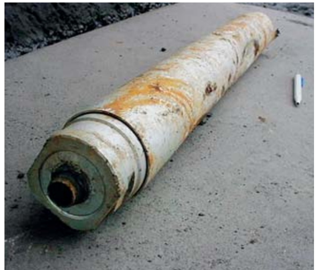
11 Sonda con una sorgente radioattiva per la misurazione dell'umidità.
