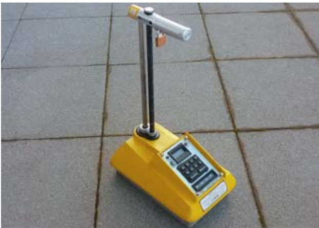
2 Sonda di misurazione del suolo per la misurazione della densità e dell'umidità del bitume o del catrame.
