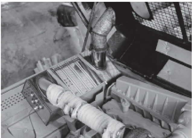
SHW-Filter auf Raupenbagger CAT 330 an der Stelle des Auspuffschalldämpfers montiert.
