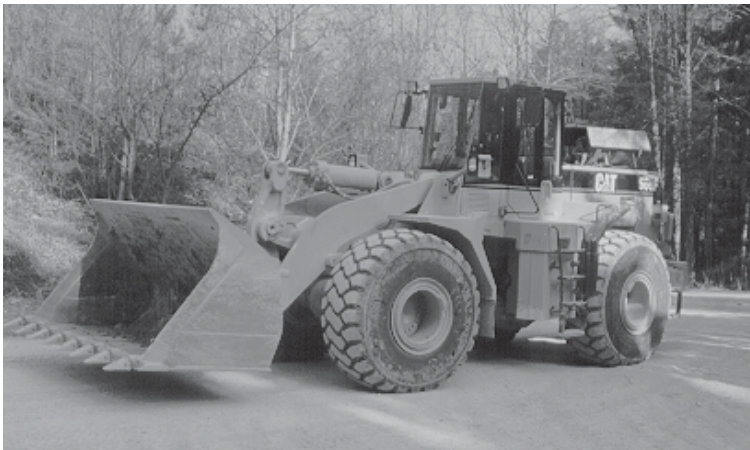
Bild 1: Ein mit einem DSI-Russfilter ausgerüsteter Radlader Caterpillar 966 F im harten Einsatz in einem Steinbruch.
