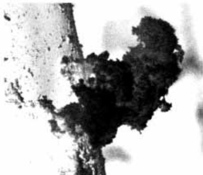
Bild 1: Dieselmotoren, abgeschieden als Feinstpartikel und Agglomerate auf einer Keramikfaser mit 10 \mu Durchmesser
