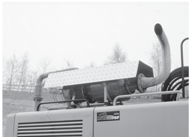
KHD/DSI-Filter auf Raupenbagger Liebherr 942 aufgebaut. Für die Feldversuche wurde die Sichteinschränkung für den Fahrer toleriert. Im Normalfall müsste der Filter unter die Haube.
