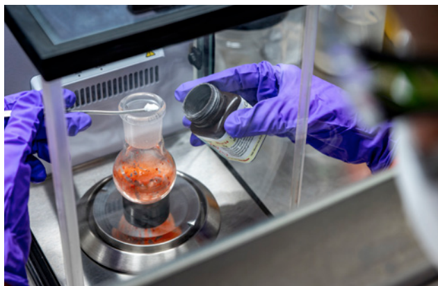
2 Mesure de protection technique: pesage dans une cabine de pesée avec EPI supplémentaires.
