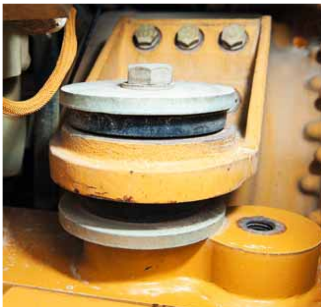
Bild 13 Vibrationsentkoppelndes Element eines modernen Fahrzeugs mit vibrationsentkoppelter Fahrerkabine.
