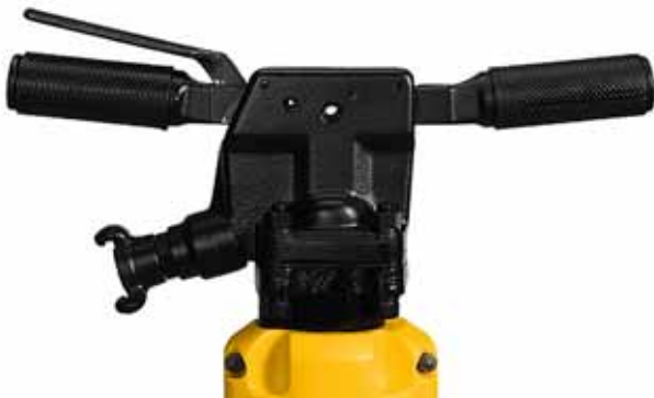
Bild 17 Vibrationsreduktion eines Abbauhammers
