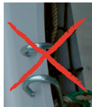
3 I moschettoni aperti perdono molto in termini di resistenza. In generale, non vanno utilizzati per montare le reti.
