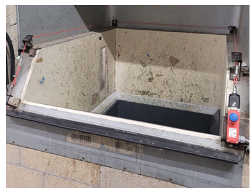
3 Direktbeschickung von Hand mit zusätzlichen Schutzmassnahmen
