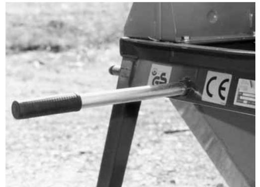
Bild 5: Handgriffe erleichtern das Transportieren der Maschine.
