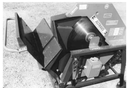
Bild 4: Die Wippe muss in der Ausgangsstellung das Sägeblatt vollständig verdecken.
