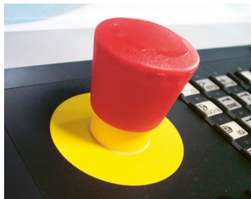
4 Dispositivo di arresto di emergenza con pulsante azionabile con il palmo della mano
