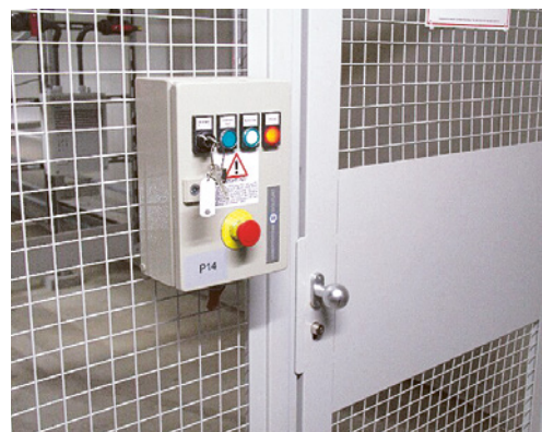
5 Pulsanti muniti di collare di protezione per evitare l'attivazione involontaria
