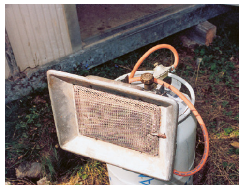
4 Bombola di gas utilizzata per riscaldarsi e cuocere i pasti. Bisogna verificare periodicamente la tenuta dei tubi del gas (soprattutto dopo l'inverno).
