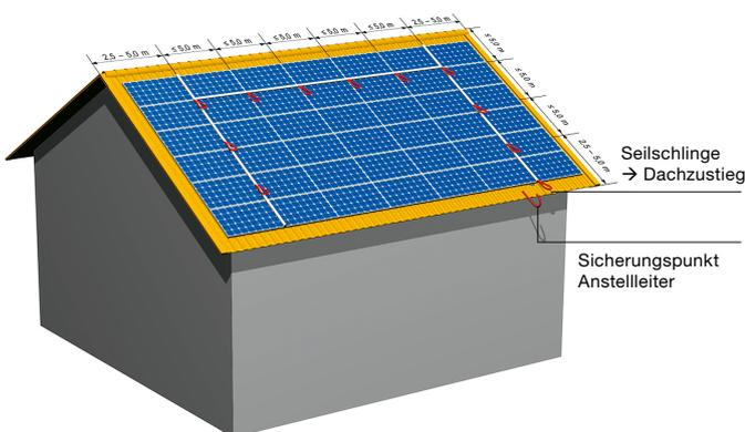
17 Beispiel einer Sicherung gegen Absturz mit Edelstahl-Seilschlingen (Achtung: Verschattung verhindern); geeignet für Dachneigungen bis 40°
