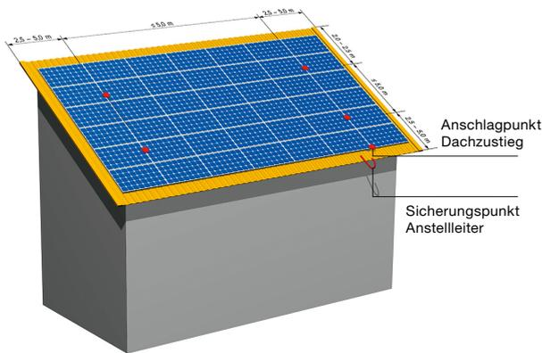
16 Beispiel einer Sicherung gegen Absturz mit Einzelanschlagpunkten bei begehbaren Solarpanels (z. B. bei einem Pultdach)
