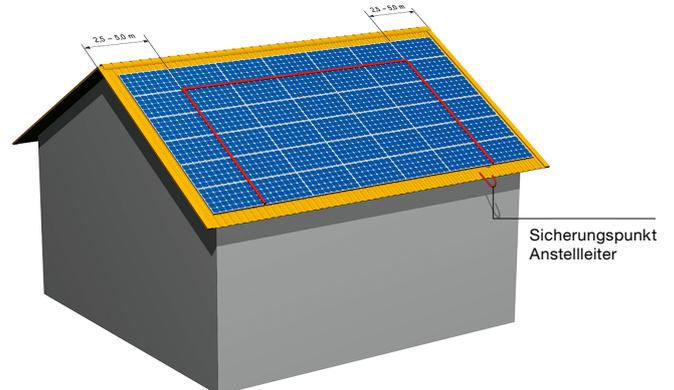
19 Beispiel einer Sicherung gegen Absturz mit Schienensystem
