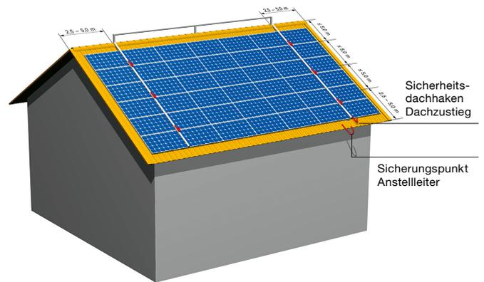
18 Beispiel einer Sicherung gegen Absturz mit Seilsicherungssystem im First, kombiniert mit Sicherheitsdachhaken
