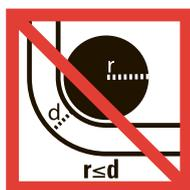
Les élingues ne doivent pas être tendues ou tirées sur les arêtes vives des charges. En présence d'arêtes vives, il faut utiliser des protections d'angle.
