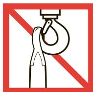
Ne pas placer l'élingue sur la pointe du crochet de levage.
