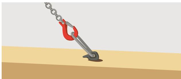
2 Vis d'ancrage de transport pour déplacer des éléments en bois
