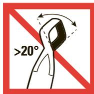
Fixer les sangles de levage munies de boucles d'extrémité de manière à ce que l'angle d'ouverture des boucles d'extrémité aux points de jonction soit de  $20^\circ$  au maximum.
