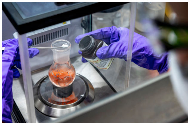
2 Misure di protezione tecniche: pesatura in un'apposita cabina con l'utilizzo di dispositivi di protezione individuale
