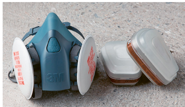
23 Eine Halbmaske mit Partikelfiltern ist mehrmals verwendbar. Mit Aktivkohlefiltern (rechts) schützt sie auch gegen Lösemitteldämpfe.
