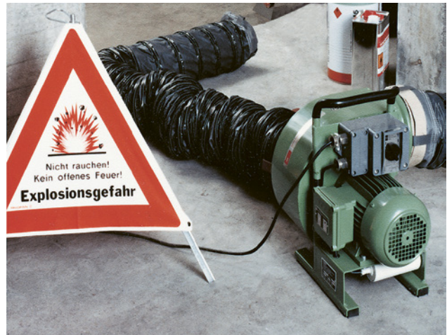
18 Verwenden Sie einen Ex-geschützten Ventilator. Saugen Sie immer ab – das ist viel effizienter als das Hineinblasen frischer Luft.
