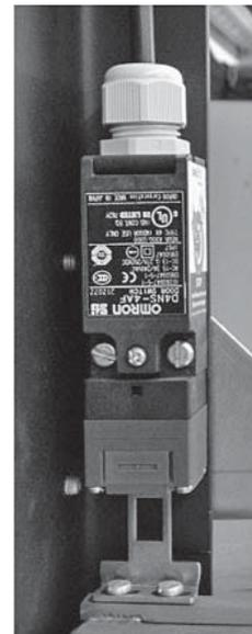
Bild 2: Ein zwangsöffnender Schalter stellt die UV-Lampe ab oder schliesst deren Blende, sobald die Anlage geöffnet wird.
