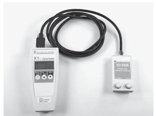
Bild 3: Zum Messen der Bestrahlungsstärke wird ein kalibriertes Optometer benötigt.
