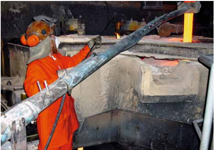
Probenahme von bleilegiertem Automatenstahl im Giesserei.
