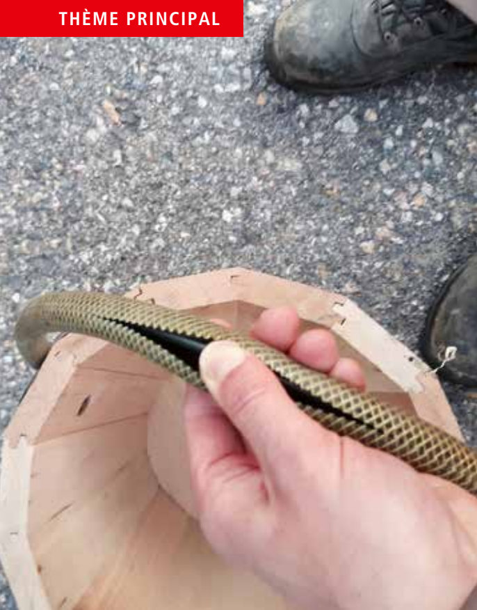
Suggestion d'employé mise en œuvre: une protection en plastique limite l'échauffement de l'asphalte chaud.
