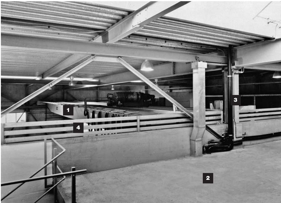
9 Zweiträgerkran in einer Fabrikationshalle. Die Fahrbahn des Krans ist vom zugänglichen Dach eines Büros aus erreichbar. Zur Sicherung der Klemmstellen zwischen Gebäudestützen und Kran ist im Zugangsbereich eine glatte, durchgehende Wand eingezogen.
